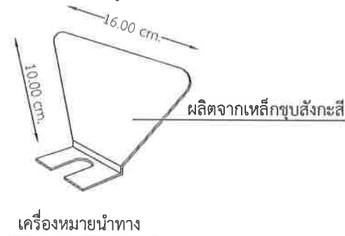
เป้าสะท้อนแสงสี่เหลี่ยมคางหมู (สำหรับติดตั้ง GUARD RAIL)
