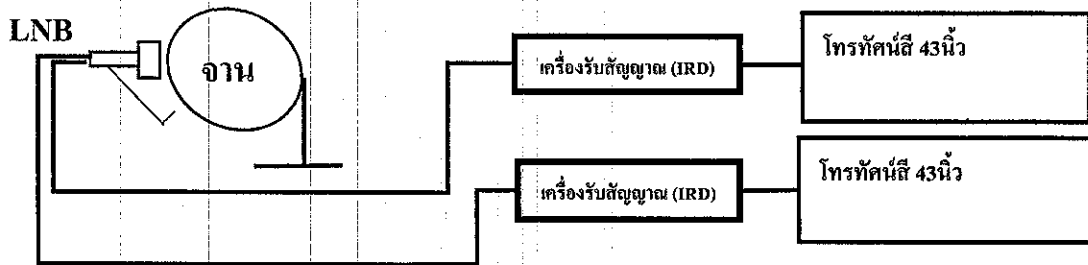
ภาพประกอบการติดตั้งจานดาวเทียม กลุ่มที่ 2
