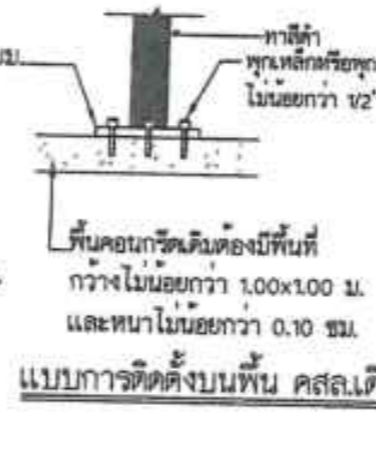
หมายเหตุ ขนาดของเสาเหล็ก 95x95 มม. เกรดที่ ความคลาดเคลื่อนยอมให้ ± 1.5 มม.
