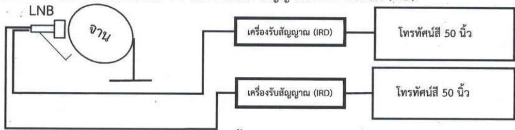
ภาพประกอบการติดตั้งจานดาวเทียม กลุ่มที่ 2
