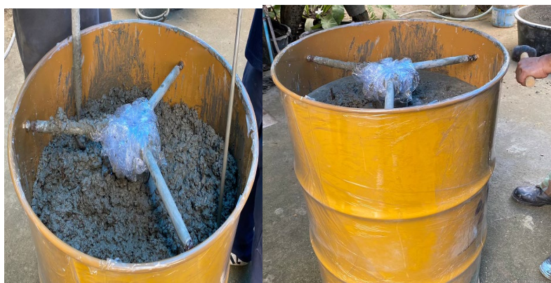
รูปที่ 22 การทำคอนกรีตให้แน่นและไล่อากาศโดยใช้เหล็กกระทุ้งภายในถัง และการใช้ค้อนยางเคาะภายนอกถัง
