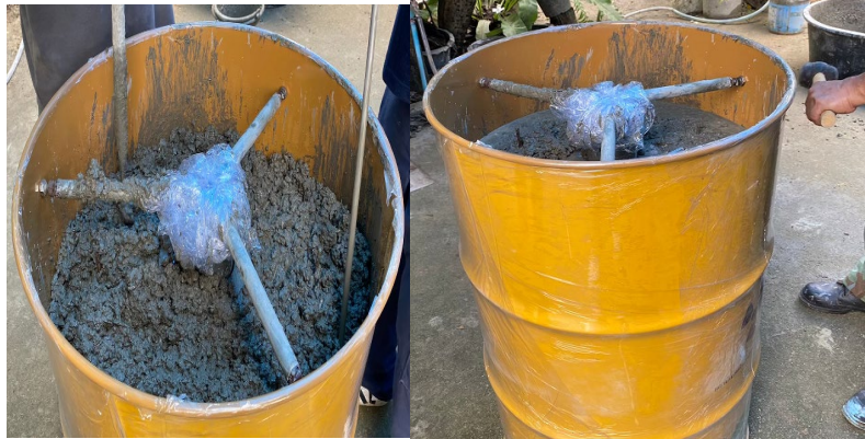
รูปที่ 14 การทำคอนกรีตให้แน่นและไล่อากาศโดยใช้เหล็กกระทุ้งภายในถัง และการใช้ค้อนยางเคาะภายนอกถัง
