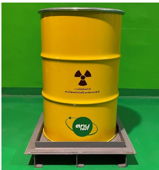
รูปที่ 24 พาเลทสำหรับวางภาชนะสำหรับการจัดเก็บรักษากากกัมมันตรังสีชนิดปิดผนึกที่เป็นวัสดุ กัมมันตรังสี ประเภทที่ 3 -5 หลังจากการปรับสภาพแล้ว ประเภท CC12CAP
