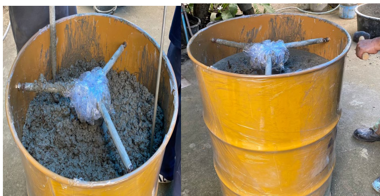
รูปที่ 4 การทำคอนกรีตให้แน่นและไล่อากาศโดยใช้เหล็กกระทุ้งภายในถัง และการใช้ค้อนยางเคาะภายนอกถัง
