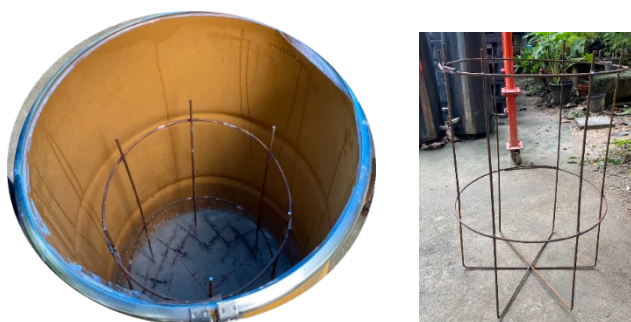
รูปที่ 20 โครงสร้างเหล็กเสริมและการบุด้วยคอนกรีตที่ฐาน
