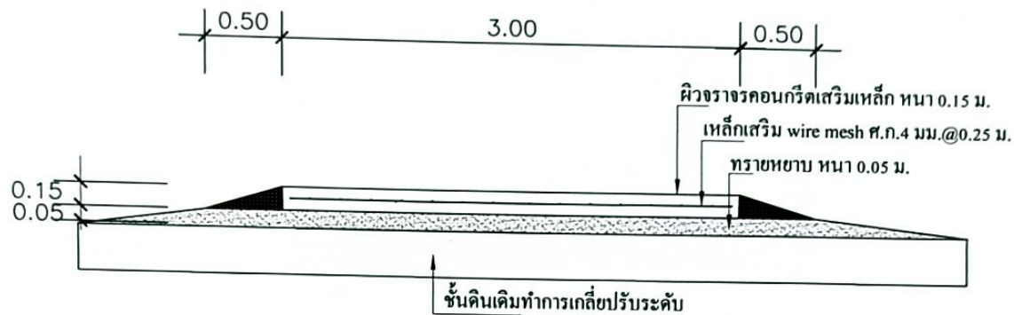
แปลนถนนคอนกรีตเสริมเหล็ก Scale 1:25
