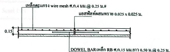
ขยาย EXPANSION JOINT Scale 1:25
