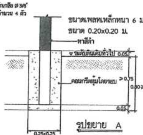
หมายเหตุ ขนาดของเสาเหล็ก 95x95 มม. เกณฑ์ ความคลาดเคลื่อนยอมให้ \pm 1.5 มม.
