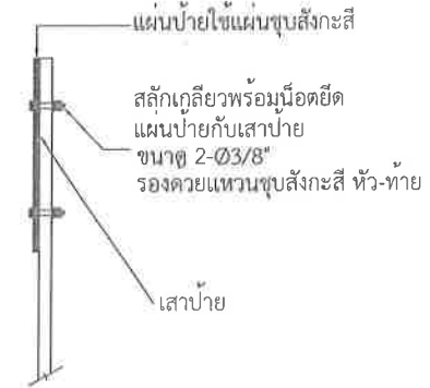
แสดงตำแหน่งการติดตั้งป้ายบังคับ ป้ายเตือน
