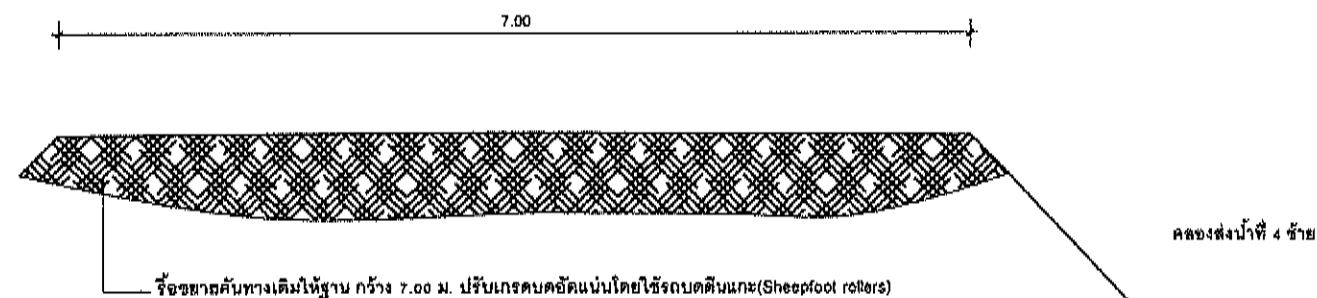
รูปตัดขยายคันทางเดิม SCALE 1:100
