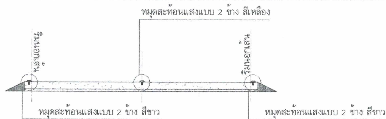
รูปตัดระยะติดตั้งหมุดสะท้อนแสง (Road Stud) Not to scale
